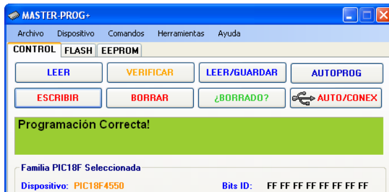
Figura 25. Firmware grabado con éxito al PIC18F4550.
